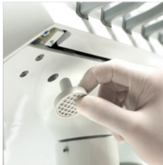
Ölabscheider für die Schmiermittel der rotierenden Instrumente.
