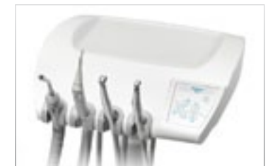
Instrumentenelement, schwenkbar für Rechts- und Linksbehandlung geeignet. 3-F Spritze, Absaugung serienmäßig, Turbine und Mikromotor optional mit oder ohne Licht.
