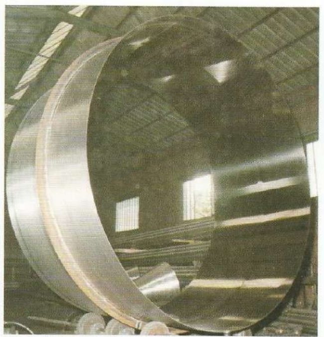
Serbatoio Ø 2980 mm e lunghezza 2000 mm lucidato interno e satinato esterno Tank Ø 2980 mm and length 2000 mm. Processing: Internal lustre polishing and external fine satin finish (6)
