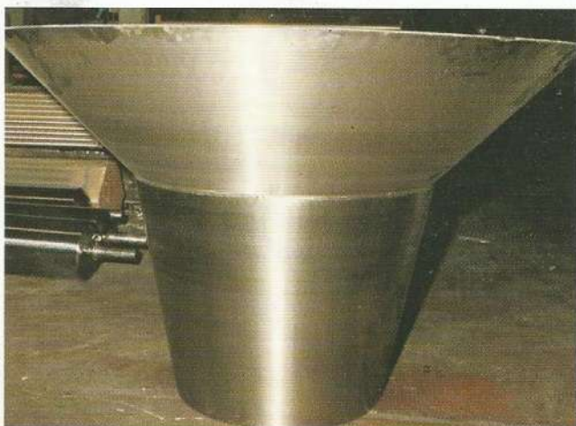
Cono da Ø 1800 mm a Ø 600 mm e lunghezza 1200 mm satinato esterno
