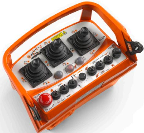
BRAVO è la nuova elettronica con controlli proporzionali; è inizialmente proposta con lo scafo M che può essere personalizzato su specifica; programmabile fino a 8 uscite analogiche, joystick proporzionali singolo/doppio asse, in corrente o tensione e fino a 28 uscite on/off.
