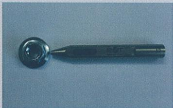
Einfache 1-Kanal Lösung für Standard-Rissprüfung mit Sensoren am rotierenden Teil.
