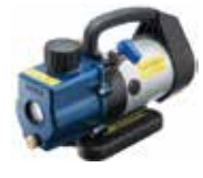
Pompa Vakum Dua Tahap - TAS00012 Type Rotor : 2 Tahap Kapasitas pemindahan : 1.4CFM (40L/Mnt) Kekuatan Vakum : 38 Micron (220V, 200W) Putaran per menit : 3.200 Rpm Kapasitas Oli : 140 ml Ukuran : 10 x 26 x 17 cm (4,3 Kg) – termasuk adapter (5/16 & 1/4)
