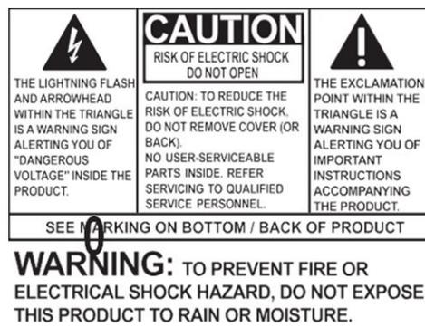
Der Blitz und die Pfeilspitze im Dreieck bilden ein Warnsignal, das Sie vor "gefährlicher Spannung" im Inneren des Produkts warnt
