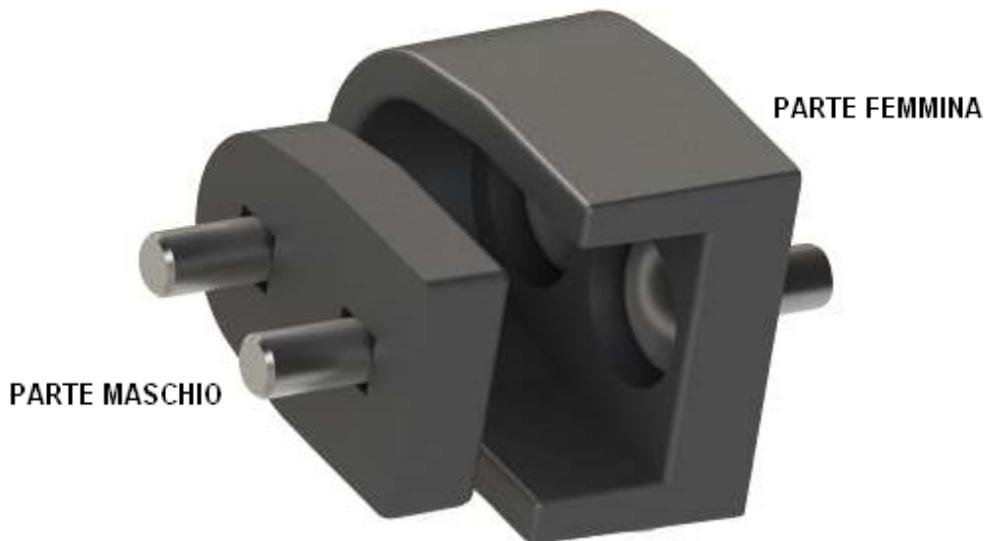
Il pattino di centraggio è composto da due parti: la parte femmina viene fissata sul montante della cabina, la parte maschio sulla portiera; In tal modo si assicura sempre un perfetto allineamento e la salvaguardia della serratura anche in presenza di porte particolarmente pesanti o gioco sulle cerniere.
