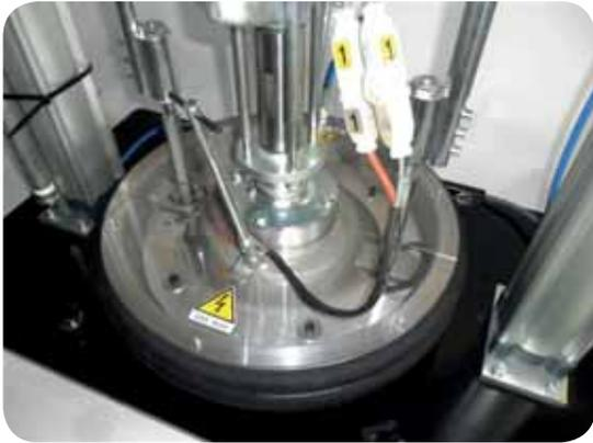
Piatto premente riscaldato con doppia guarnizione toroidale per fusto It.200 a potenza maggiorata
