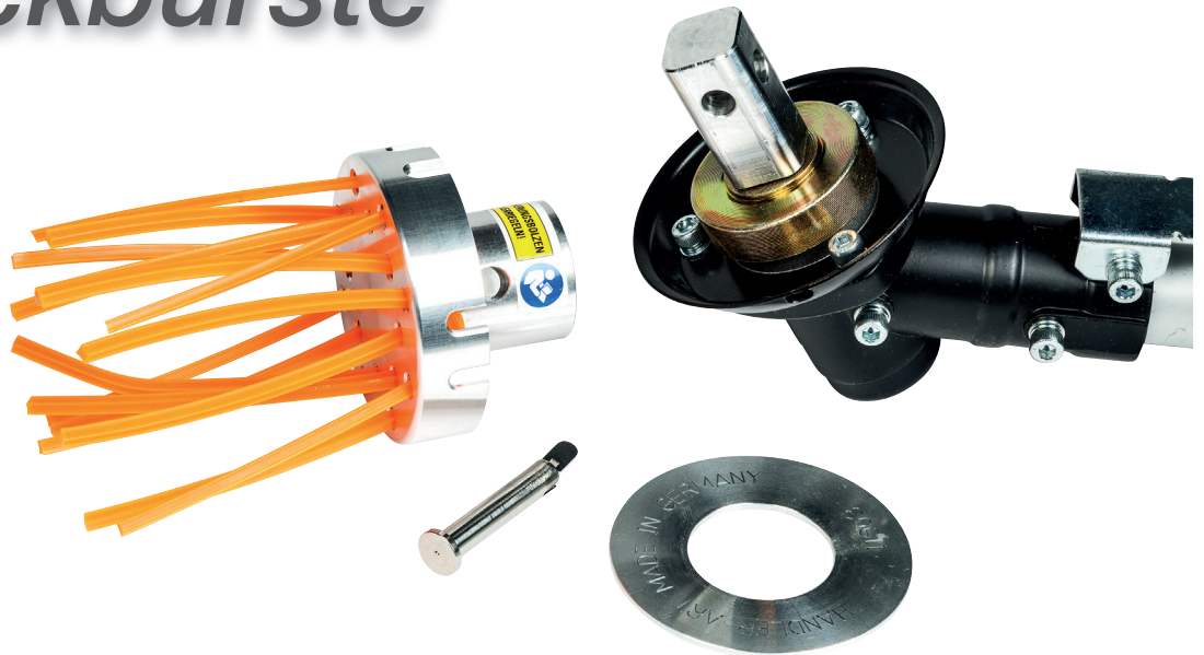
Als Kupplung zwischen Maschine und Fadenkopf fungiert ein massiver Alublock. Über einem Querbolzen wird dieser mit dem Fadenkopf verbunden. Mit 8 Fäden bestückt arbeitet der Fadenkopf als „Wildkrautbürste“
