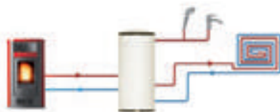
Riscaldamento a pavimento Underfloor heating
