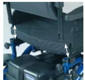
Schienale facilmente rimovibile tramite due pomelli svitabili a mano.
